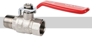
ONYX Robinet sferic nichelat, pasaj total, cu presetupă și manetă de oțel (versiunea cu filet interior-exterior)
